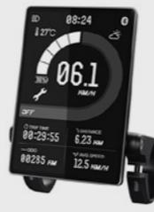
Tutti i dati importanti sono mostrati in modo chiaro su di un monitor confortevole BMZ DS 103. È operativo utilizzando un comando remoto che è collegato attraverso un cavo e posto vicino alla manopola.
